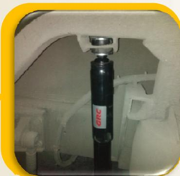
2. Coloque el amortiguador con la suspensión arriba
