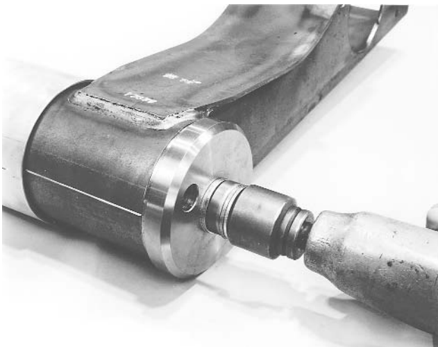
Figura 33. Instalando el buje con la pistola de impacto
