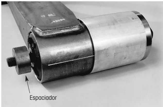
Figura 15. Instalando el espaciador
